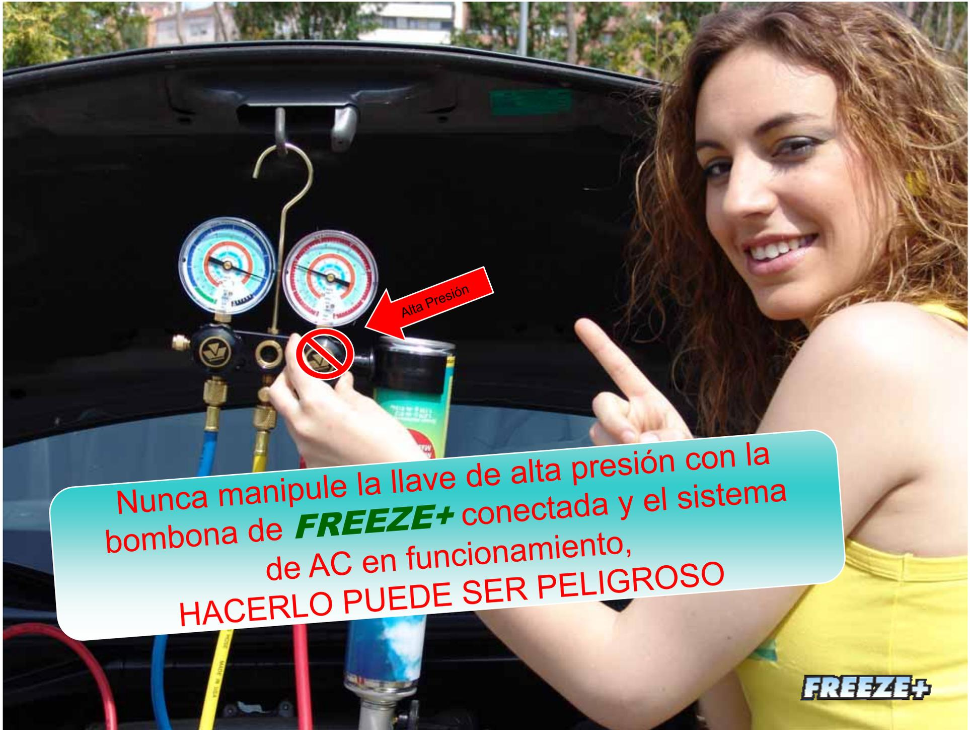
Nunca manipule la llave de alta presión con la bombona de **FREEZE+** conectada y el sistema de AC en funcionamiento, HACERLO PUEDE SER PELIGROSO
